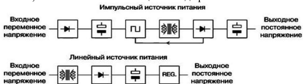
Рис. 2 – Порівняння блок-схем лінійного і імпульсного джерел живлення
